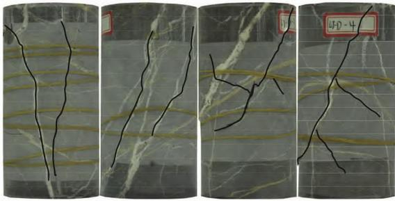
图 8 常规三轴下灰岩破坏模式
